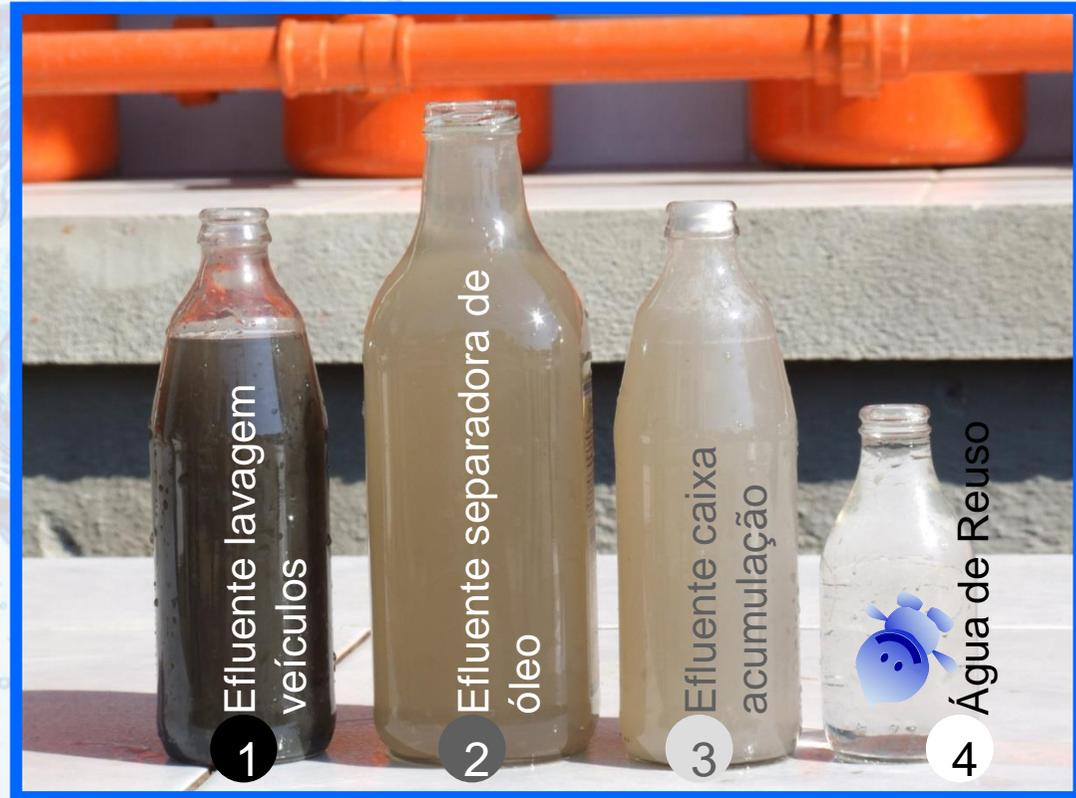
21 Detalhe da Turbidez do Efluente ao Longo do Sistema
